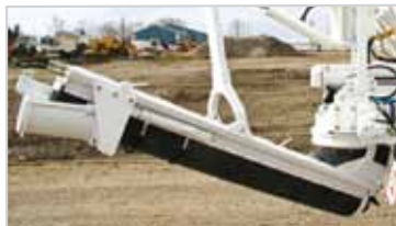
Vis de malaxage plus large : 330 mm
